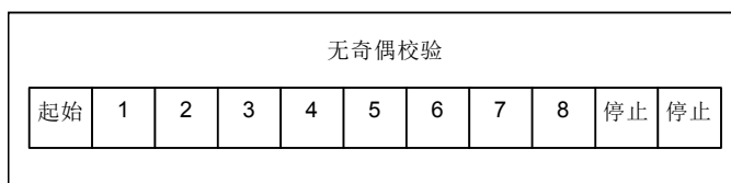
图 10: RTU 模式位序列(无校验的特殊情况)
